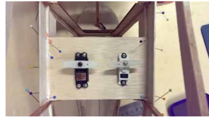
Plaatsen van de richtings- en hoogteroerservo.
