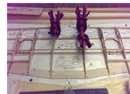
De bouw van de vleugels.
