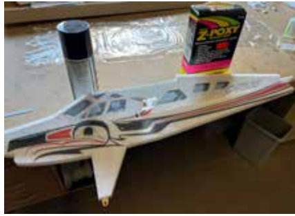
De rompf flank wordt vlak op de rand van de tafel gelegd waarna daar haaks een tweede en een derde deel wordt gelijmd.
