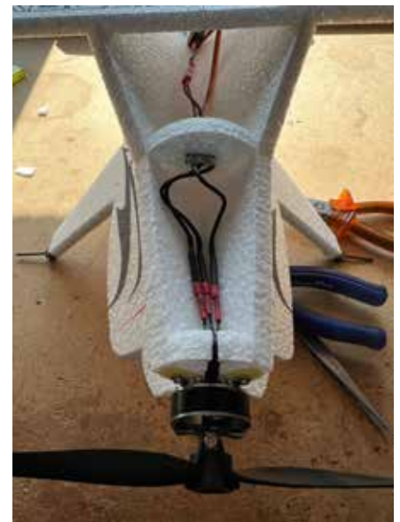
Een kunststof kruis wordt op de neus gelijmd, de motor gemonteerd en de bedrading keurig naar achter geleid.
