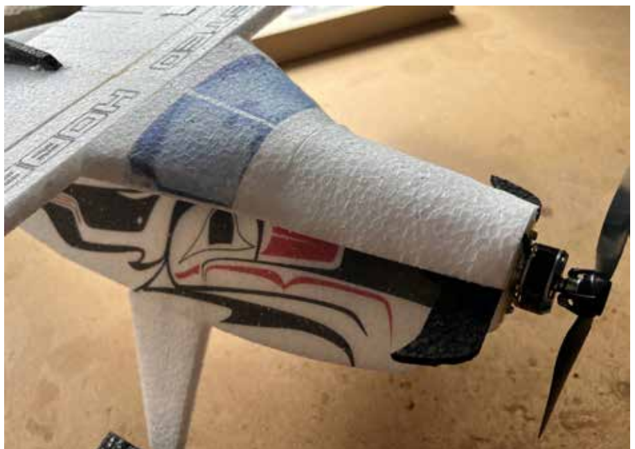
De neus wordt mooi afgerond en dicht gebouwd. Twee zwart uitstekende stukjes EPP suggereren de turbo uitlaten.
