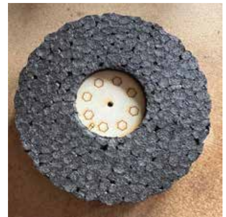
De EPP-banden, voorzien van een triplex velg.
