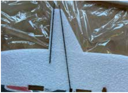
Om kracht op te vangen worden koolstof staafjes ingelijmd in voorziene sleuven.
