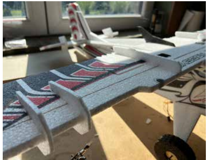
De vlakke vleugel onder constructie. Op de vleugel worden winglets gelijmd voor een betere koersvastheid.
