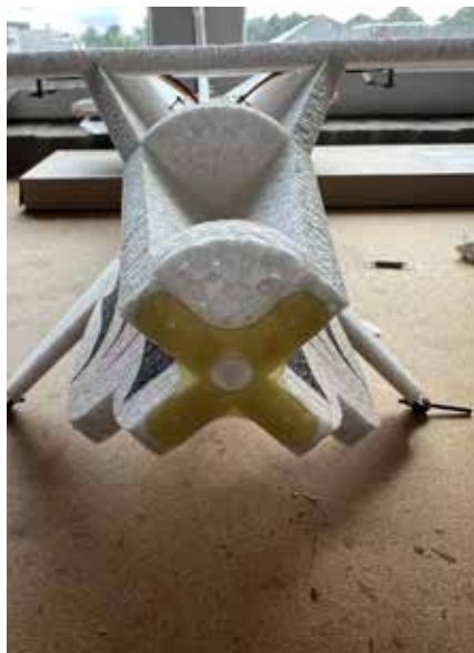
Een kunststof kruis wordt op de neus gelijmd, de motor gemonteerd en de bedrading keurig naar achter geleid.
