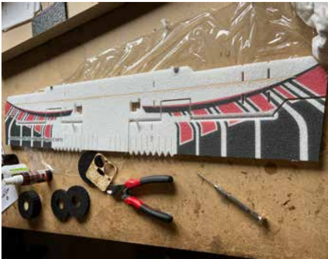
De vlakke vleugel onder constructie. Op de vleugel worden winglets gelijmd voor een betere koersvastheid.
